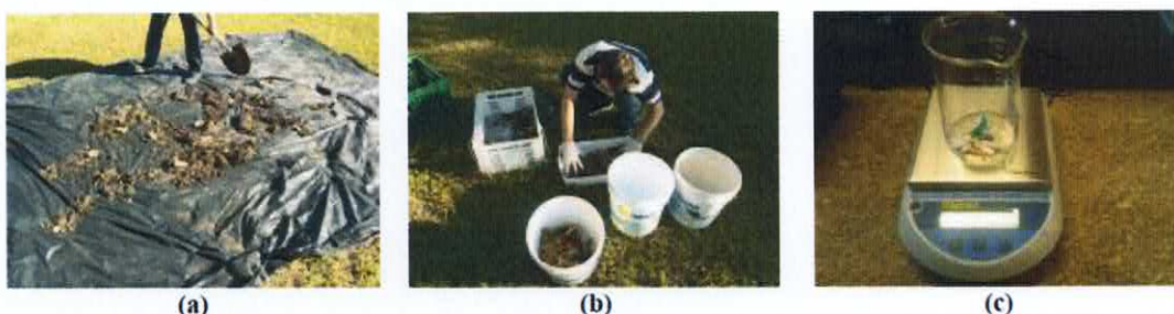
Figura 7: a) Material coletado espalhado para secagem natural; b) Separação dos materiais; c) Rejeitos triados – bitucas de cigarro (Fonte: os autores, 2012)
