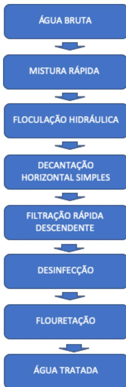
O sistema de tratamento, embora classificado como convencional, de forma geral dispõe de técnicas ultrapassadas, como por exemplo, floculação hidráulica e decantação horizontal simples, o que configura baixa eficiência a estes processos de tratamento.
